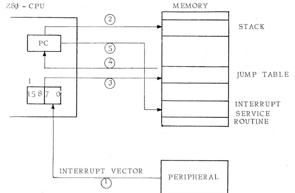
1. Con interruzioni abilitate (EI), la periferica genera una richiesta di interrupt portando la linea  $\overline{\text{INT}}$  ad un livello basso e mette il vettore di interrupt sul "data bus" quando il CPU riconosce la richiesta di interrupt.
