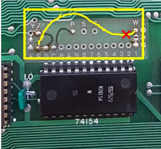
Solitamente il collegamento è effettuato con un sottile cavetto.
