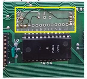
Solitamente il collegamento è effettuato con un sottile cavetto.
